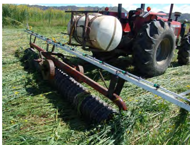
Rouleau combiné à un pulvérisateur - changer l'orientation des buses (Colombie)
