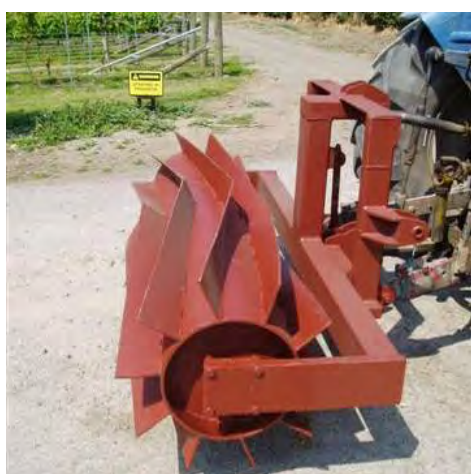
Rouleau à lames en chevron en « monte » arrière
