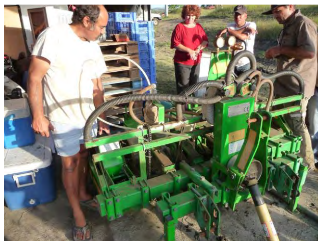
Photo n°2. Petit semoir conventionnel à distribution pneumatique utilisé par M. Yoshihama pour l'oignon
