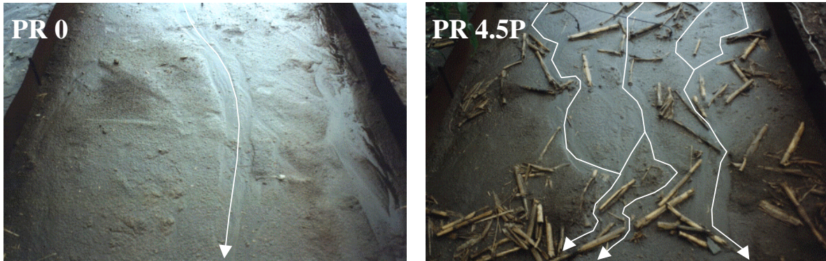
FIG. 5.2: Observation de la tortuosité des trajectoires d'écoulement sur PR 0 et PR 4.5P
