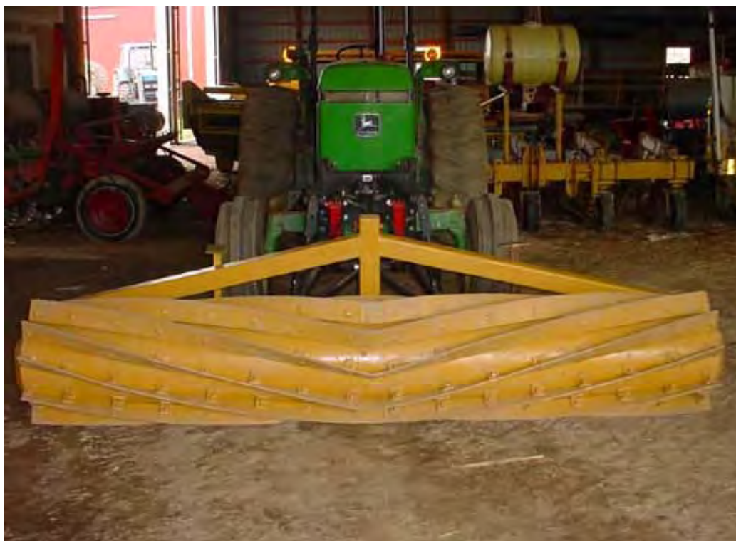
Réhabiliter le rouleau pour diminuer la charge de glyphosate dans les cultures OGM RR ( supprimer la dessiccation chimique )
