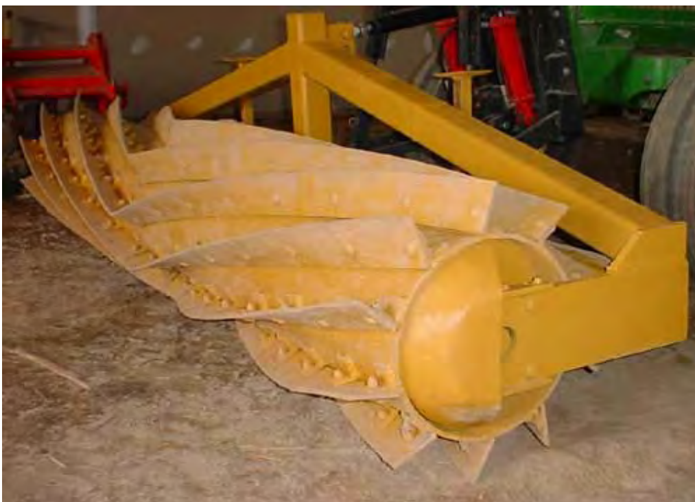
Réhabiliter le rouleau pour diminuer la charge de glyphosate dans les cultures OGM RR ( supprimer la dessication chimique )
