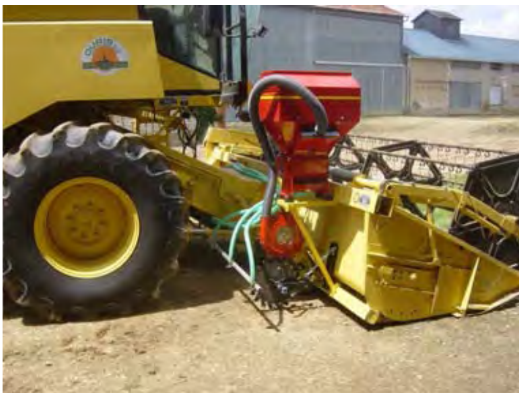
Semoirs pneumatiques pour semis simultané des petites graines (Biomasses) avec la récolte de soja ou Riz
